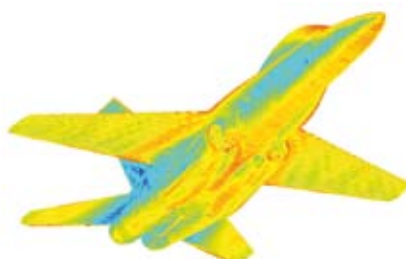
FIG. 4. CORRENTES INDUCIDAS NUN F-18 PARA UNHA INCIDENCIA AXIAL A 2GHZ, UTILIZANDO MÁIS DUN MILLÓN DE INCÓGNITAS.
