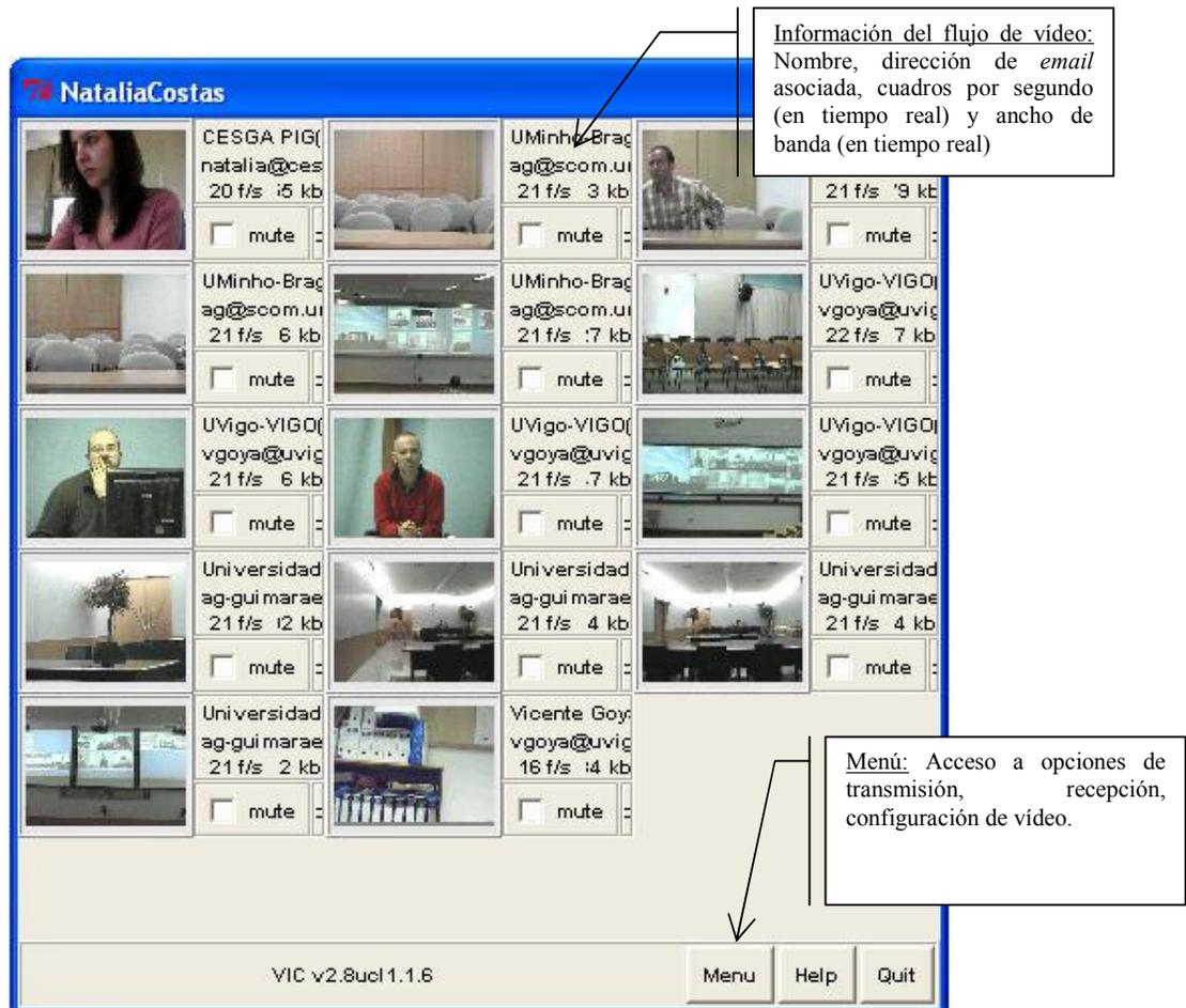
**Ilustración 5.- Captura de la ventana principal del software VIC funcionando en modo “consumidor de vídeo” (“*VideoConsumerService*”)**
