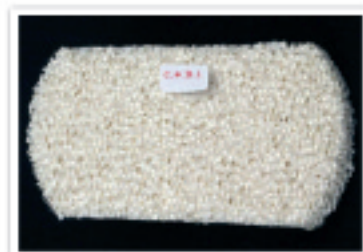
Figura 1: Imaxe dun dos novos materiais desenvolvidos. Neste caso, unha espuma de cerámica.
