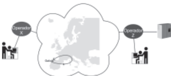
Percorrido que realiza a información cando un usuario da RECETGA solicita acceso ó servidor do Cis Madera no Parque Tecnolóxico de Galicia en Ourense.
